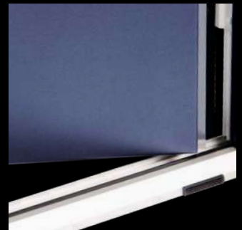
Seuil aluminium norme PMR de 20 mm Largeur passage optimale (jusqu'à 860 mm pour une largeur tableau de 900 mm)
