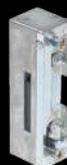
■ PÊNE JOURNALIER Complément indispensable de la barre de tirage, il permet d'ouvrir la porte sans utiliser la clé Disponibles uniquement sur portes d'entrée 1 vantail. Pour des raisons d'accessibilité le pêne journalier en position jour se déclenche avec une poussée inférieure à 50N. Une rafale de vent peut ouvrir la porte, l'installation est donc à réserver aux endroits protégés.
